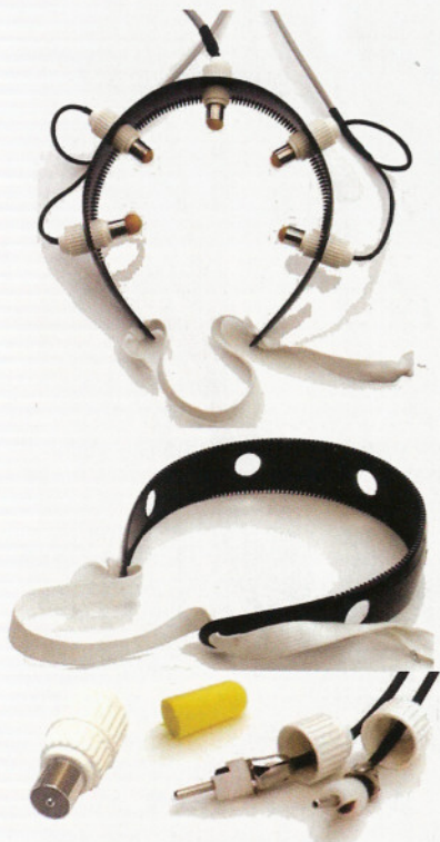
Příklad konstrukce pasivních elektrod EEG – nosnou část tvoří pásek na stažení vlasů nemocničních sester, elektrody jsou vyrobeny z běžných konektorů cinch a na snímací kontakt je nasunuta molitanová vložka z miniaturních sluchátek (špuntu) napuštěná solným roztokem
